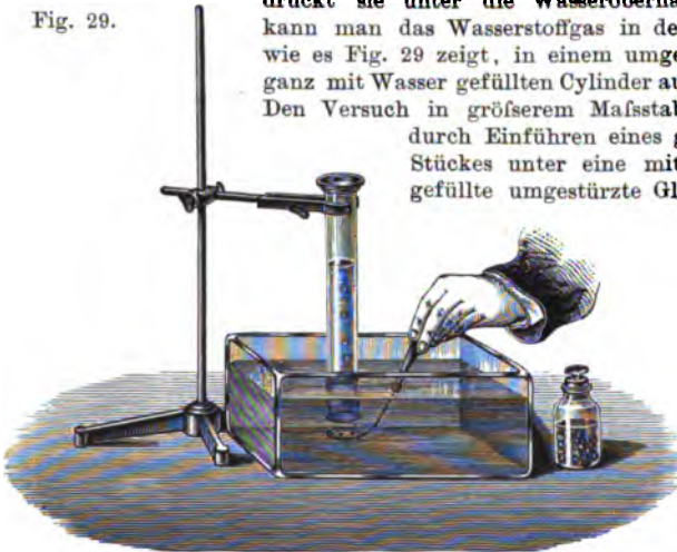
Wasserstoffentwicklung mittels metallischen Natriums.
